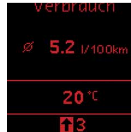
La indicación multifunción "Plus" con indicador de recomendación de cambio de marcha integrado, le indica en qué marcha circular para minimizar el consumo de combustible.
